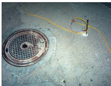
Imágenes de colocación de electrodos en un vial.
